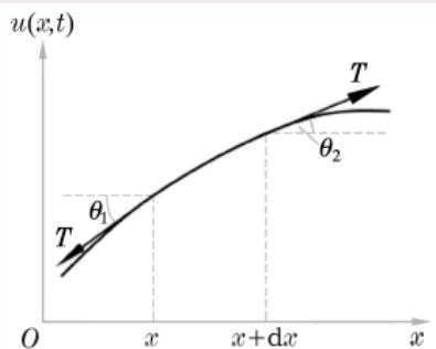
因为弦是完全柔软的，故只受到切向应力——张力 $T$ 的作用，而没有法向应力。同时，略去了重力的作用。因此有
