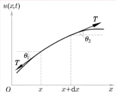
因为弦是完全柔软的，故只受到切向应力——张力 $T$ 的作用，而没有法向应力. 同时，略去了重力的作用. 因此有
