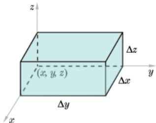
若六面体内无其他热量来源或消耗，则根据能量守恒定律，净流入的热量应等于介质在此时间内温度升高所需的热量
