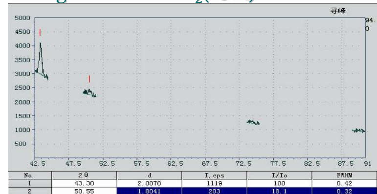
Fig.15 In 10 -SiO 2 (退火)
